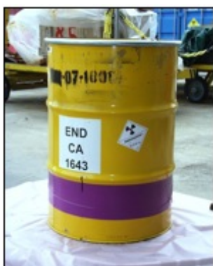
Fût métallique de boues et concentrats cimentés
