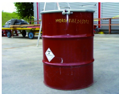
Fût métallique de déchets cimentés
