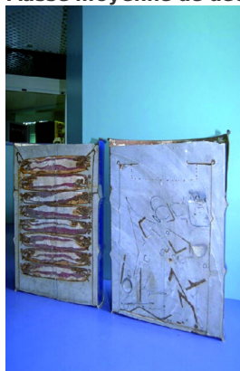
Coupe d'un colis pour contrôle
