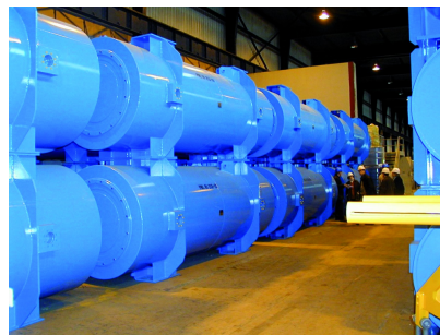
Colis de PNL en ouvrage de stockage
