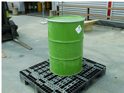
Fût métallique de déchets cimentés
