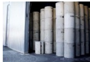
Coques béton contenant des fûts métalliques de boues et concentrats
