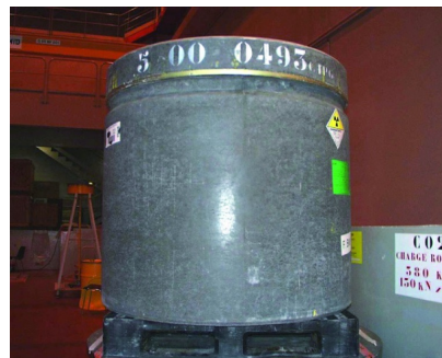
Coques béton de boues et concentrats cimentés
