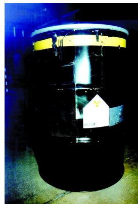
Fût métallique de déchets compactés et cimentés
