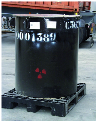
Fût métallique de concentrats cimentés
