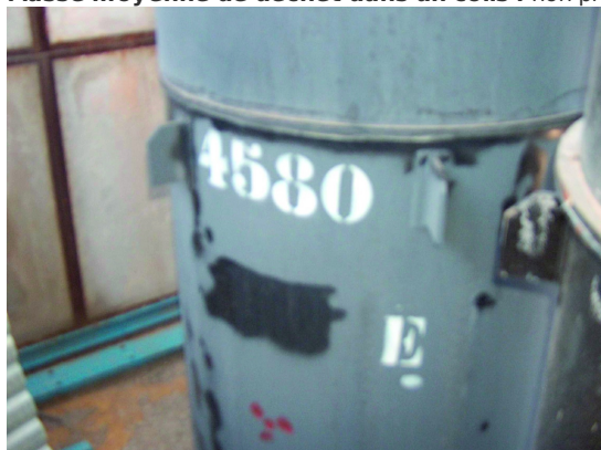
Fût de paratonnerres au radium (870 litres)
