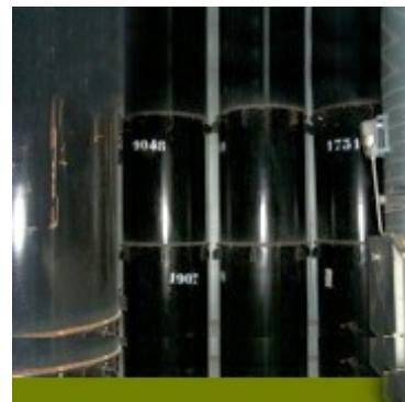
Conteneurs métalliques de concentrats cimentés
