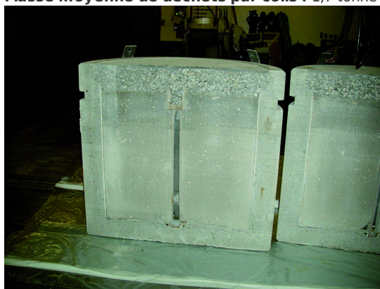
Coupe d'une coque béton pour expertise
