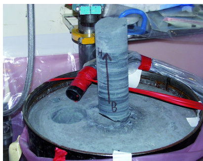
Extraction d'une carotte, d'un fût de cendres cimentées, pour expertise
