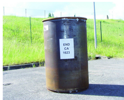
Fût métallique de résidus d'incinération cimentés
