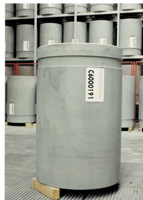
Colis béton-fibres cylindrique
