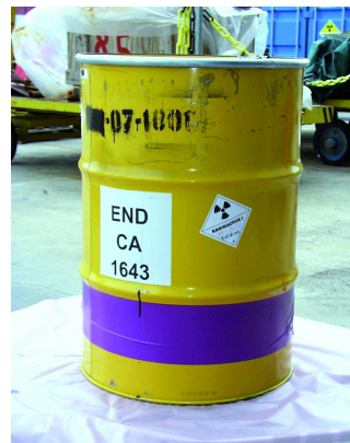
Fût métallique de boues et concentrats cimentés
