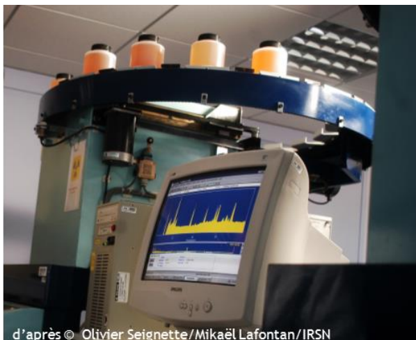
Figure 2 - Mesure de la radioactivité au sein d'échantillons urinaires par spectrométrie \gamma dans le cadre d'analyses radiotoxicologiques
